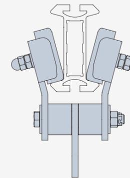
Der mobile Anschlagpunkt der Schiene bietet zusammen mit einem Hörsicherungsgerät das bestmögliche Auffangsystem.
