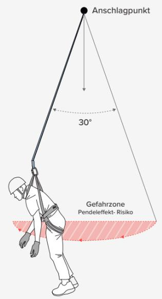
Einige Höhenarbeiten umfassen ein Risiko aufgrund des Pendeleffekts. Der Nutzer kann seitwärts pendeln. Ein Winkel von max. 30° von der Anschlagvorrichtung wird empfohlen, um den Pendeleffekt zu minimieren.
