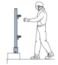
Persönliche Absturzsicherungssysteme minimieren Verletzungen im Falle eines Sturzes, wobei die Rückhaltesysteme verhindern, dass eine Person sich einem absturzgefährdeten Bereich nähert. Kollektivschutz bietet einen sicheren Arbeitsbereich für alle.
