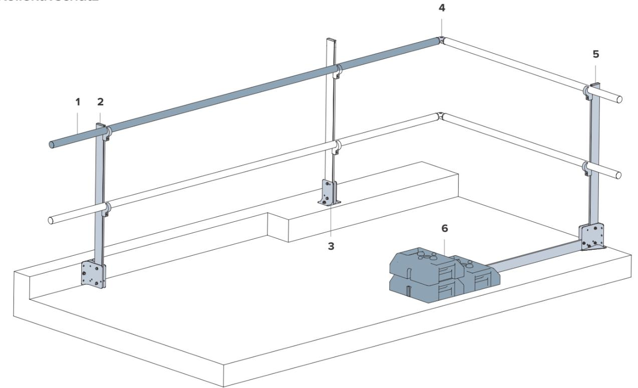
Das Geländer ist die empfohlene Absturzsicherung in stark frequentierten Bereichen. Es dient als Schutzbarriere, die den Benutzern einen sicheren Zugang zu bestimmten Stellen ermöglicht, um Arbeiten auszuführen und grenzt gefährliche Bereiche ab. Das Geländer wird entlang des Dachrandes oder um Oberlichter herum installiert, was einen einfachen Zugang ermöglicht, ohne dass man eine PSA benötigt, um sich gegen Absturz zu schützen.
