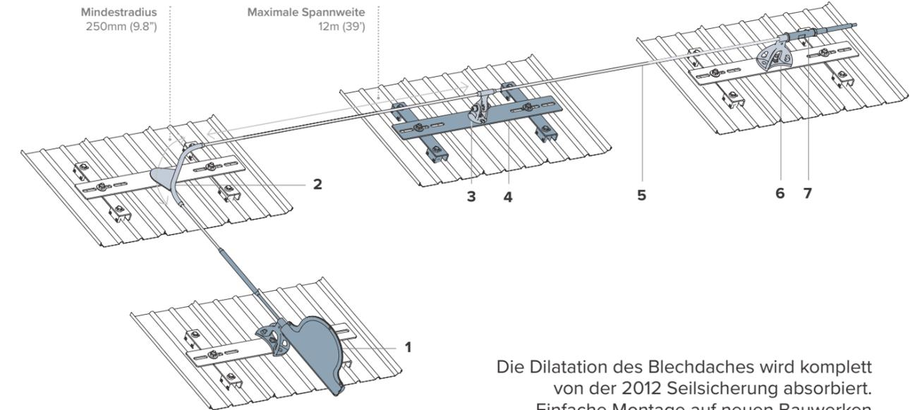
Die Dilatation des Blechdaches wird komplett von der 2012 Seilsicherung absorbiert. Einfache Montage auf neuen Bauwerken oder existierenden Gebäuden.
