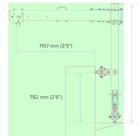
Die Stabilität des Wagens wird durch zwei Laufwagen gewährleistet, die das Kippmoment aufnehmen dank der Safeaccess-Schiene aus Aluminium, die an Pfosten oder Konsolen an der Struktur des Daches oder der Attika befestigt ist. In der Parkposition wird der Mast waagrecht gekippt und dann vom Wagen abgenommen. Im Betrieb wird der Ausleger auf die Dachseite geschwenkt, um die Kunststoffseile an den 2 Ankerpunkten einzuhängen.
