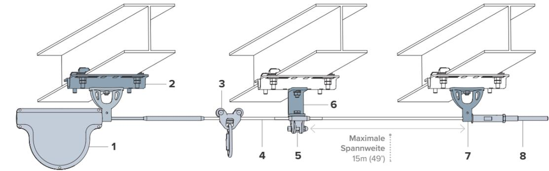
Die NEO SecuRope Seilsicherung kann ber ein Klemmsystem an Tragern befestigt werden. Die Verwendung dieser Befestigungsart ermoglicht eine feste Fixierung der Seilsicherung ohne Bohren. Sie eignet sich besonders fur Industrieanlagen mit unterschiedlichen Tragerprofilen, denn die Durchbiegung des Kabels sehr gering ist.
