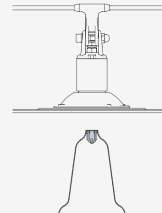
**NEO Anker auf Befestigungs-vorrichtung SpotAnchor**
