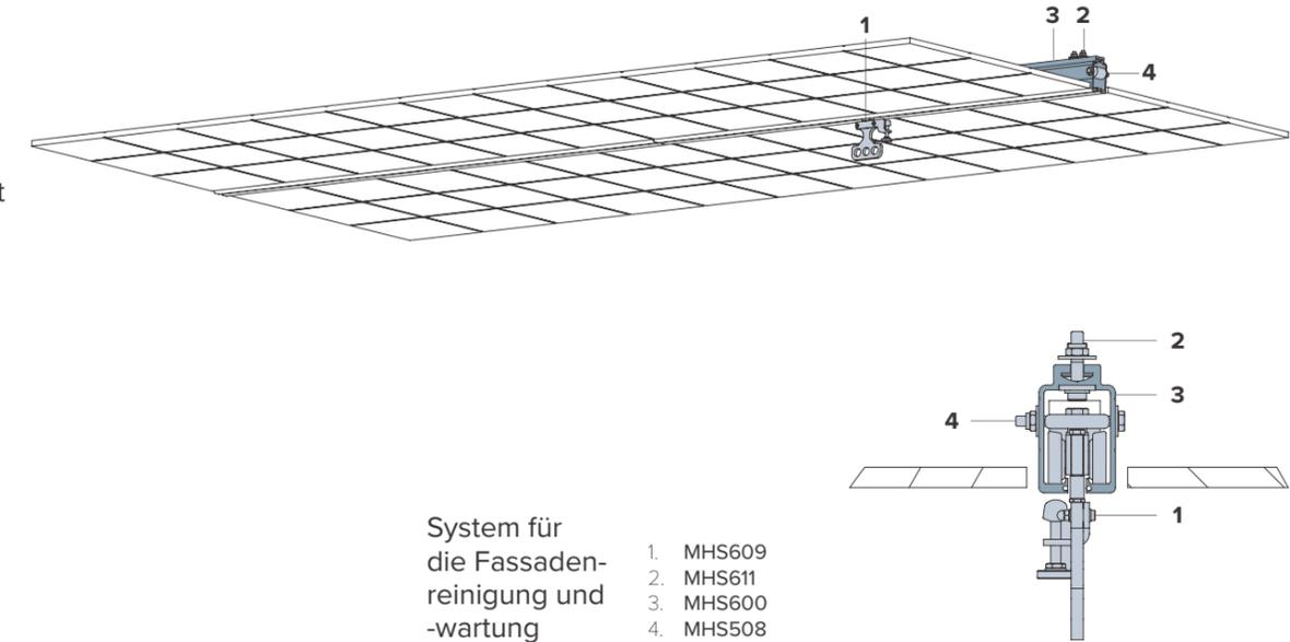
System für die Fassadenreinigung und -wartung
